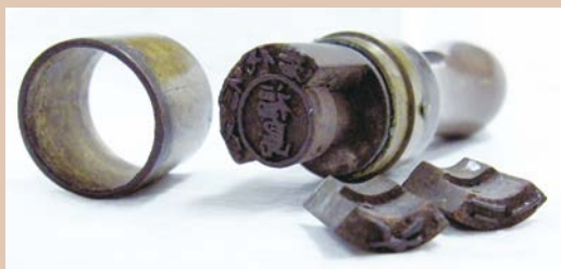
左上) 福島郵便役所の二重丸型日付印 明治7年頃 右上) 上記日付印を分解した状態 左) 印影 岩代(旧国名)・信夫(郡名)・福島(局名)・六(月)・二一(日)
